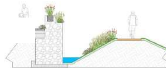
Kanāls ar gabiona atbalsta sienu
